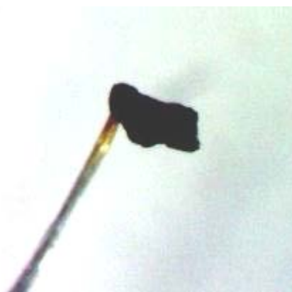
Фота 41. Рэакцыя на спаленне шаўковай ніці (а – кантрольны узор натуральнага шоўку, б – іспытуемае валакно)
