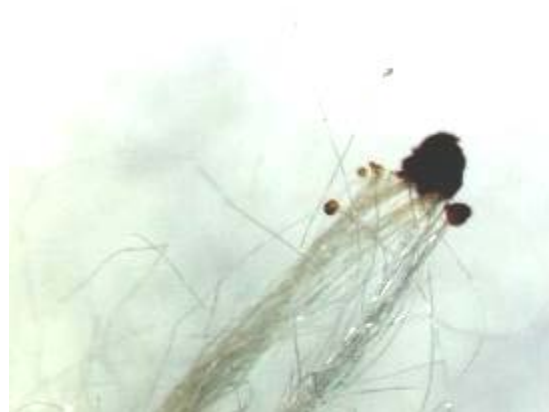
Фота 41. Рэакцыя на спаленне шаўковай ніці (а – кантрольны узор натуральнага шоўку, б – іспытуемае валакно)
